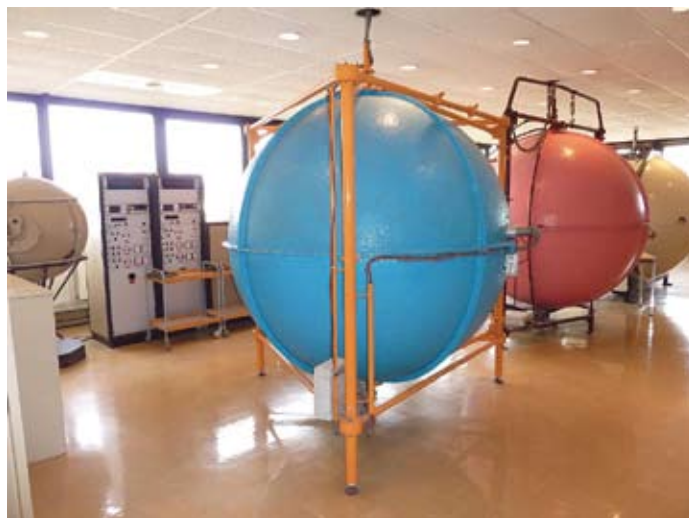
Systèmes de mesures : Le département Qualité mesure le flux lumineux et toutes les autres caractéristiques des lampes tels que le courant, la température de couleur, etc.
